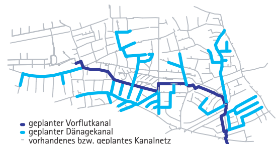
Dränagenetz zur Fremdwasser- und Grundwasserbewirtschaftung
